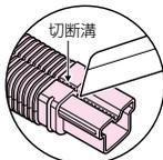
※フリージョイント裏面の切断溝に沿ってナイフ等で切断し、半割れにすれば、配管後の後付けとして使用できます。
