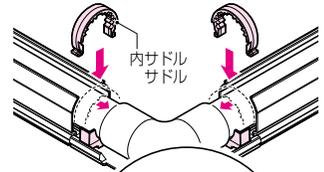
サドルを継手側にスライドさせて固定します。
