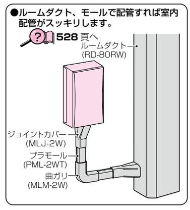
● ルームダクト、モールで配管すれば室内配管がスッキリします。
