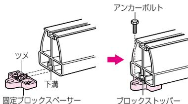
①固定ブロックの下溝にスペーサーのツメをはめ込み、ブロックストッパーを固定ブロックの前面に合わせます。
