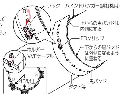
▲ケーブルをFDクリップのホルダーに取り付ける場合は、FDクリップのバンド取り付け位置に注意してください。※ケーブルが落下する恐れがあります。
