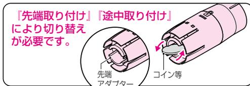
「先端取り付け」「途中取り付け」により切り替えが必要です。
