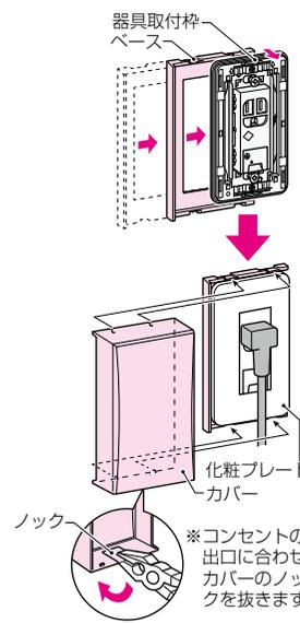
器具取付枠を浮かせ、壁とのすき間にベースを入れ、化粧プレートを取り付けます。
