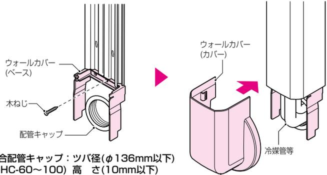
適合配管キャップ：ツバ径(φ136mm以下)
