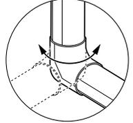
半割れタイプで冷媒管にかぶせるだけ!!
