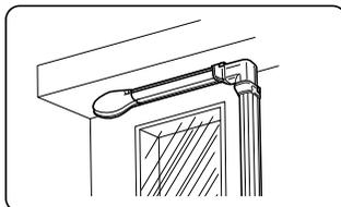
※アダプターの取り付け方向を変える事により、出ズミ・入ズミ・曲ガリ(ねじれ曲がりにも対応)としても使用できる万能エルボです。
