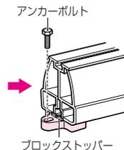
②スペーサーのボルト穴より、アンカーボルト等で下地床に固定します。
