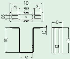
●C形鋼にLアングルを固定し、パッケージエアコン等を取り付ける場合に使用します。※取り付けには、市販のボルトナットが別途必要です。
