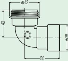
●マルチドレンホースの気密試験を行う際に、室内機側継手に取り付けて使用するキャップです。
