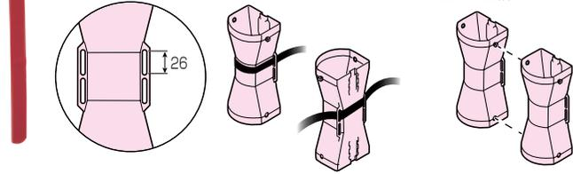
●側面の突起部を穴にはめ込むと連結ができます。
