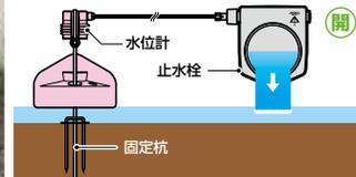
設定した水位に到達すると止水栓の弁が閉じ、水が止まります。
