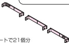
Aの状態から突起部の間の溝部分を折り取る。
