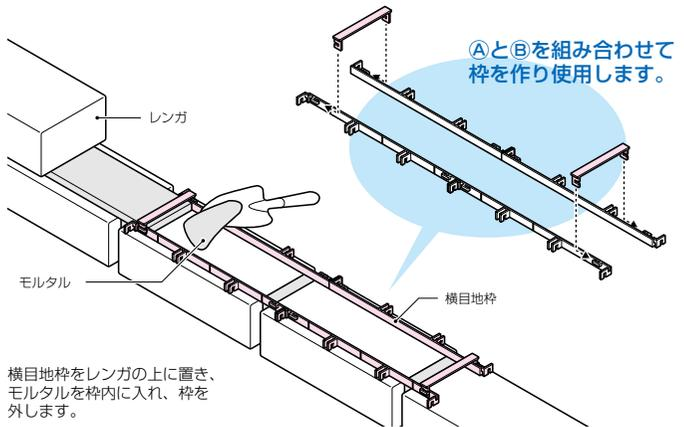
横目地枠をレンガの上に置き、モルタルを枠内に入れ、枠を外します。
