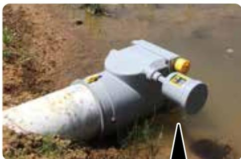
タイマーを止水栓に取り付け、止水までの時間を設定します。
