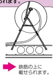
※上記写真は別売のサヤ管をセットしたイメージ写真です。サヤ管の引き出しには付属のビニールカバーを取り付け、PPバンドを切断して引き出してください。
