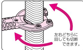
カッターを120°回転させ、切断します。切れ端を抜き取った後、カッターを差し込んだ位置に戻し、取り外します。※元の位置に戻さないと取り外せません。
