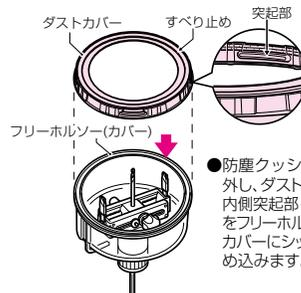
●防塵クッションを外し、ダストカバー内側突起部(4箇所)をフリーホルソーのカバーにシッカリはめ込みます。
