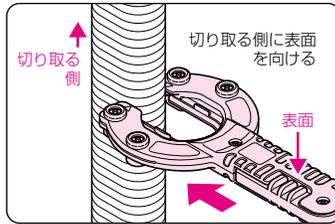
ダ円サヤ管の切り取る側に、表面を向けて差し込みます。
