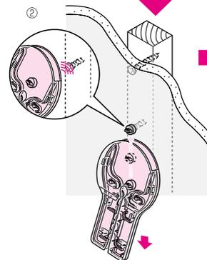
② マーカーが木ビスに反応して引っ張られたらアッターを下げてマーカーを本体から抜き取ります。(マーカーが壁に引っ付きます。)
