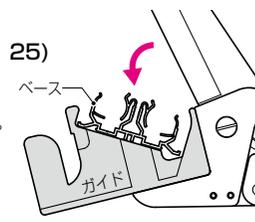
●配管モール40、配管モールクアトロ、ルームダクトはカバーとベースを別々に切断します。
