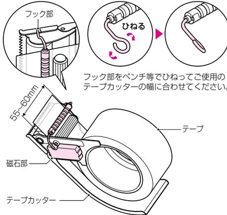
テープカッターサポートの取り付けには、磁石部を取り付ける金属面に30×7mmの平面が必要です。
