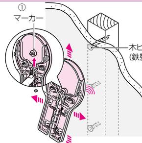
① マーカー1個を指で押し出し、アッターで壁面をなぞりながらマーカーが金属(木ビス)に反応する場所を探します。
