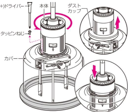
●タッピンねじは締め過ぎないでください。樹脂が破損し、固定できなくなる恐れがあります。
