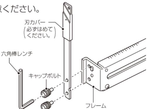
●キャップボルト・締め付けツマミは、緩みがないよう堅牢に固定してください。
