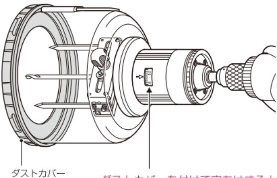
ダストカバーを付けて穴あけすると設定深さより3~4mm深く開きます。必ず深さ目盛りをその分3~4mm浅く設定してください。
