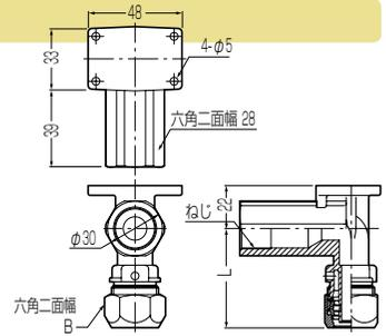
※取り付けには、ステンレス製木ねじ(呼び4.1×長さ35mm以上)を4本で使用ください。
