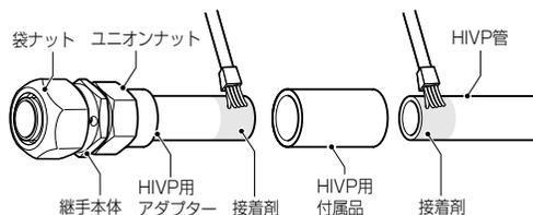
① HIVP管及びHIVP用アダプターの接着面に接着剤を均一に塗布し、HIVP用付属品の奥までシッカリ差し込み接着固定します。
