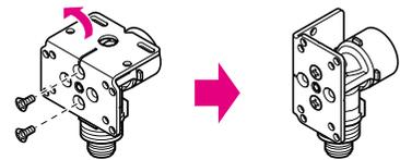
座裏側の固定ねじを外し、座を取り付けたい方向に回して固定ねじでしっかり固定します。
