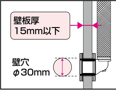
ユニットバス貫通継手用座金(UBP-L)を使用すれば、壁穴 $\phi 50\text{mm}$ まで対応できます。
