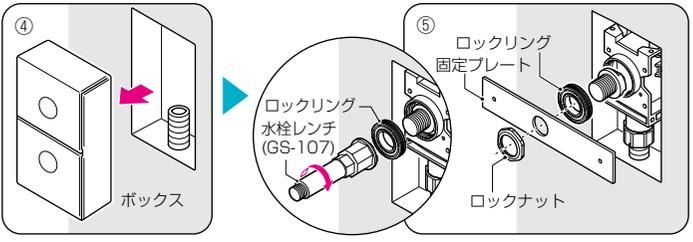
⑥水栓エルボに固定プレートを取り付け、ロックナットで固定し、コンクリート面にコンクリートビス等で固定します。
