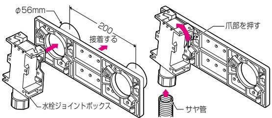
①予め、水栓取り付け位置に合わせてユニットバス壁パネル裏にバックハンガーを取り付け、φ56mmの穴を開けておきます。
