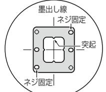
バックスペーサーを調整厚に合わせて重ね、その上に水栓ジョイントボックスを重ねてネジ等で固定します。
